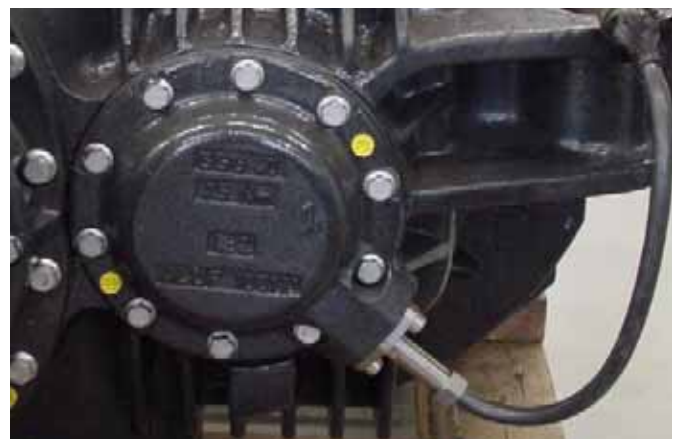
JAQUET Drehzahlensensor eingebaut in Bahngetriebe
