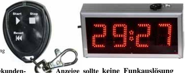
**Achtung:** Bei Stoppuhren mit 1/100-Sekunden-Anzeige sollte **keine Funkauslösung** vorgesehen werden, insbesondere, wenn 2 oder mehrere Stoppuhren parallel fungieren sollen. Bei unterschiedlich entfernten Funkquellen besteht die Möglichkeit, dass der Signalempfang, physikalisch bedingt, im 1/100-Sekundenbereich nicht zeit-synchron ist. Insofern kann beim **Parallelbetrieb von 2 oder mehr Anzeigen** keine Garantie für exakt synchrone Ergebnisse auf den Anzeigen übernommen werden.
