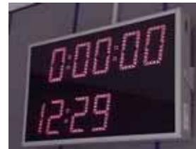
Neben der Möglichkeit der Umschaltung zwischen **Uhrzeit- und Stoppuhrfunktion** kann auch ein **Kombi-Anzeigen-Tableau** geliefert werden **bei dem beide Funktionen parallel dargestellt werden**. Auf der Abbildung rechts oben ist eine 6-stellige Stoppuhr und eine 4-stellige Uhr zu erkennen; selbstverständlich wäre auch die Kombination von 2x 4-stelligen Anzeigen möglich. Bei einer Ablesentfernung bis ca. 40 m würde sich insofern anbieten
